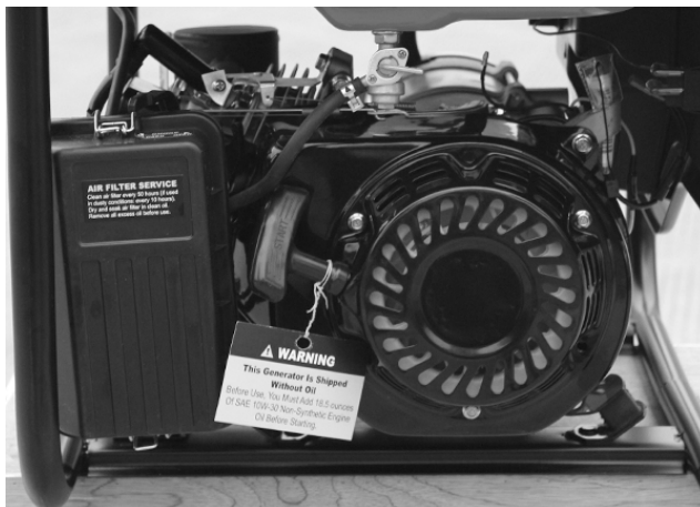
Figura 4 El arranque manual está ubicado a la izquierda del generador.
