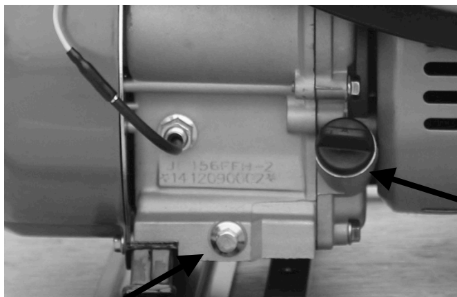
Figura 8A – QUITAR el tapón con una llave hexagonal de 12 mm y drenar el aceite.
